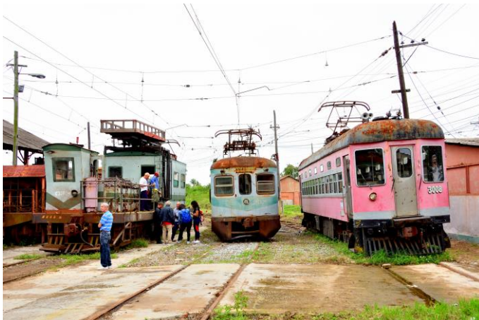
Illustration 15 : les trois types de véhicules en service. Le niveau de corrosion des caisses démontre le manque de moyens d'entretien
